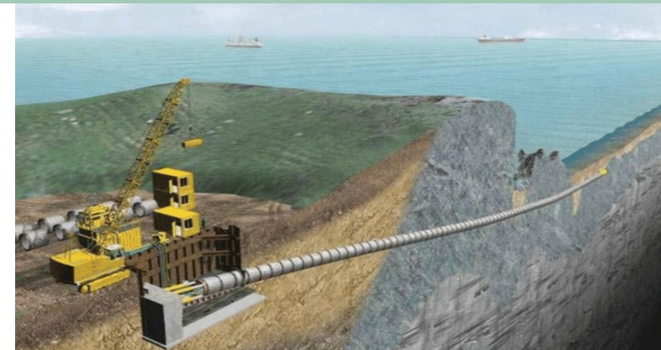
Posa della condotta mediante tecnica di «microtunneling»
